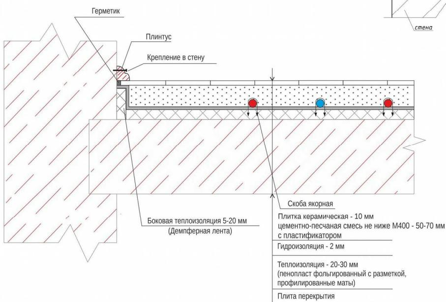
Пирог конструкции напольного отопления занимает 100мм, самое эффективное покрытие — это плитка керамическая, керамогранитная, каменная и др. Использование ламината, ковролина и линолеума существенно снижает мощность теплого пола и срок службы покрытия.
