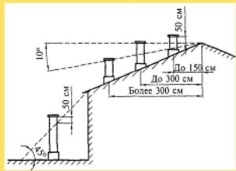
При отводе продуктов сгорания от теплогенератора через наружную стену (допускается, если до соседнего участка от стены с дымоходом 3м и более), необходимо выдержать минимальные расстояния:
